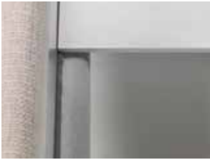
2. GUARNIZIONE PARAPOLVERE Dust seal
